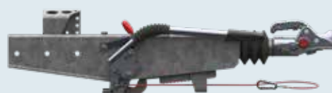
Åtdragen handbromsspak = spädd bromsstång, nedsänkt handbromsspak
