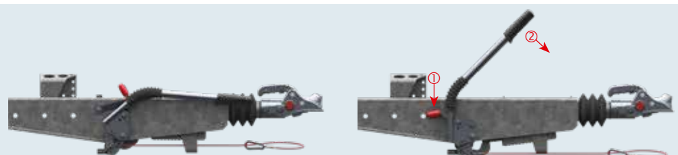
Öppen handbromsspak = bromsstången inte spädd
