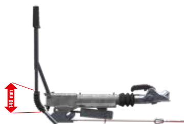
Stängd handbromsspak (parkeringsbroms bakåt, bromsen optimalt inställd)
