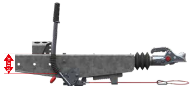
Stängd handbromsspak (parkeringsbroms bakåt, bromsen optimalt inställd)
