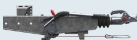
Alavanca do freio de mão aberta = tirante não tensionado
