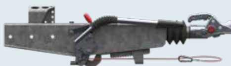
Alavanca do freio de mão apertada = tirante tensionado, alavanca do freio de mão rebaixada
