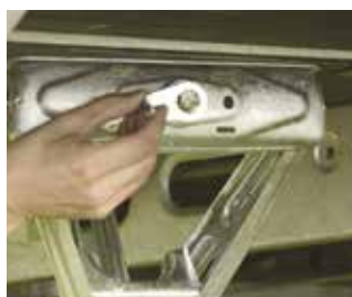
Insira a proteção contra torção do fuso
