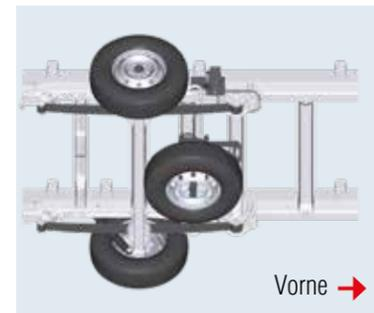
Montage **HINTER** der Hinterachse
