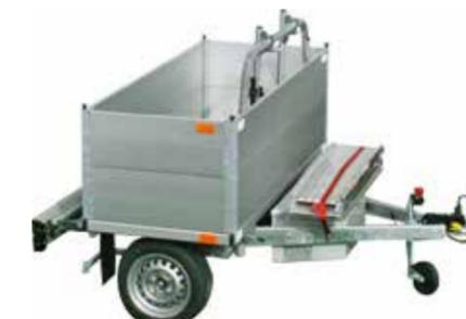
Aluminium Bordwände 600 mm Höhe auf WHEELY
