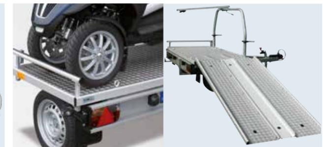
Rüstsatz Dreiradroller mit 3-teiliger Auffahrschiene
