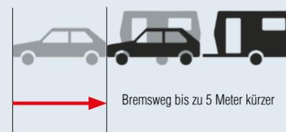
Jeder Meter weniger Bremsweg ist ein „Mehr“ an Sicherheit. Die AAA Premium Brake stellt die Bremse automatisch nach sobald sie zu viel Spiel hat. Die optimal eingestellten Bremsen bringen bestmögliche Leistung und der Bremsweg wird dadurch verkürzt.
