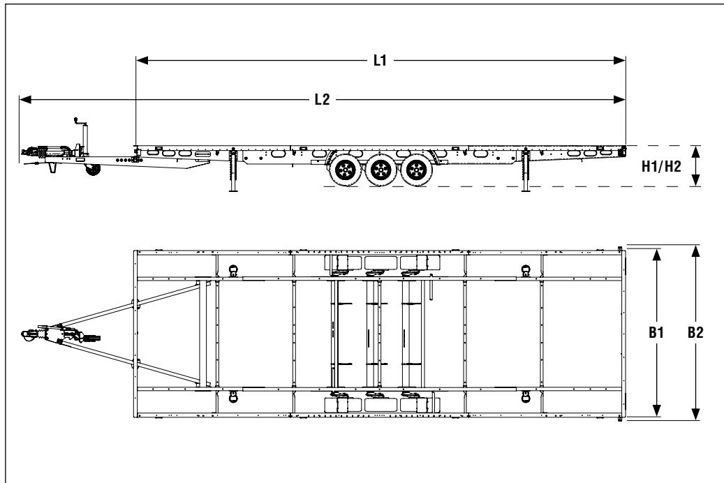
Achseinheit verschiebbar: **3-Achser** vorne ca. 200 mm / hinten ca. 440 mm
